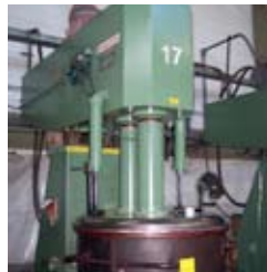
Moinho com tampa – fechamento hidráulico
